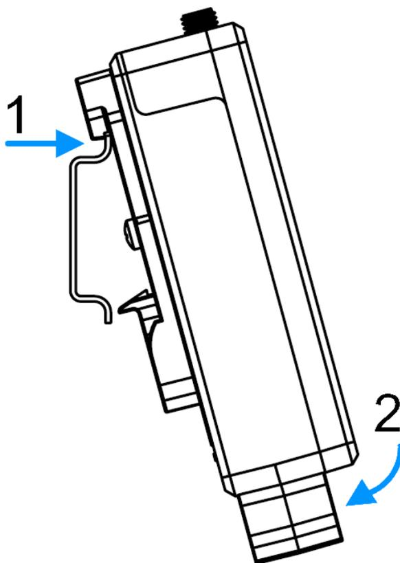
Abbildung 7: Hutschiennenmontage mit Zubehör-Adapter – Montage
