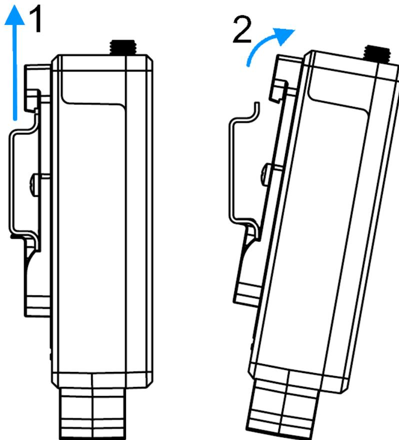
Abbildung 8: Hutschiennenmontage mit Zubehör-Adapter – Demontage
