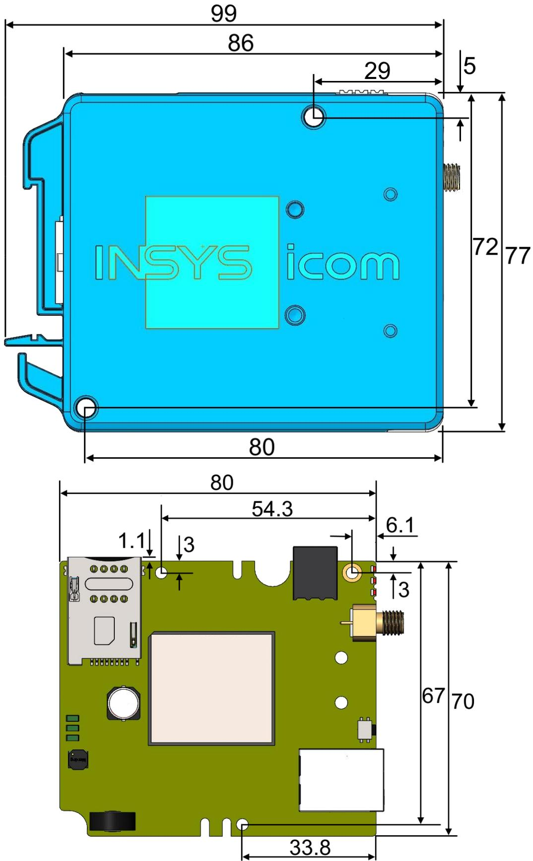
Abbildung 9: Schraubmontage – Abmessungen
