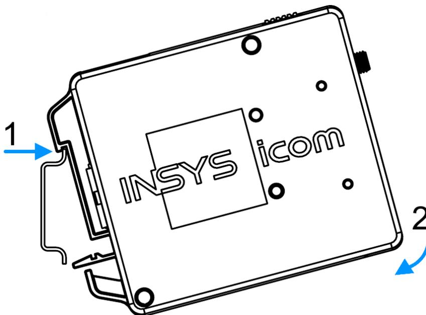
Abbildung 3: Hutschienenmontage – Montage
