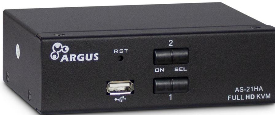
Der **KVM-AS-21HA HDMI** ist ein günstiger 2-Port KVM-Switch mit automatischem Audioschalter für den Desktopbereich.
