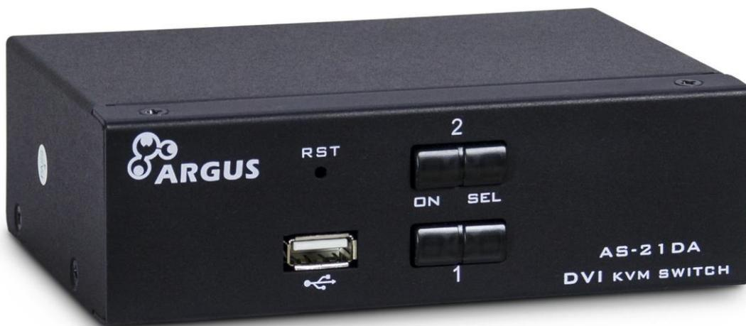
Der **KVM-AS-21DA DVI** ist ein günstiger 2-Port KVM-Switch mit automatischem Audiuumschalter für den Desktopbereich.
