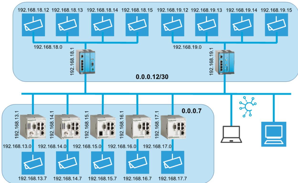
In diesem Beispiel ist für Verbindungen zu den Geräten in der unteren Gruppe die Ziel-Station 0.0.0.7 konfiguriert. Das bedeutet, dass beispielsweise im Netzwerk mit der Adresse 192.168.13.0 Verbindungen zum Gerät (Kamera) mit der IP-Adresse 192.168.13.7 über den Router mit der IP-Adresse 192.168.13.1 aufgebaut werden können. Dies gilt entsprechend auch für die anderen Geräte in dieser Gruppe.
