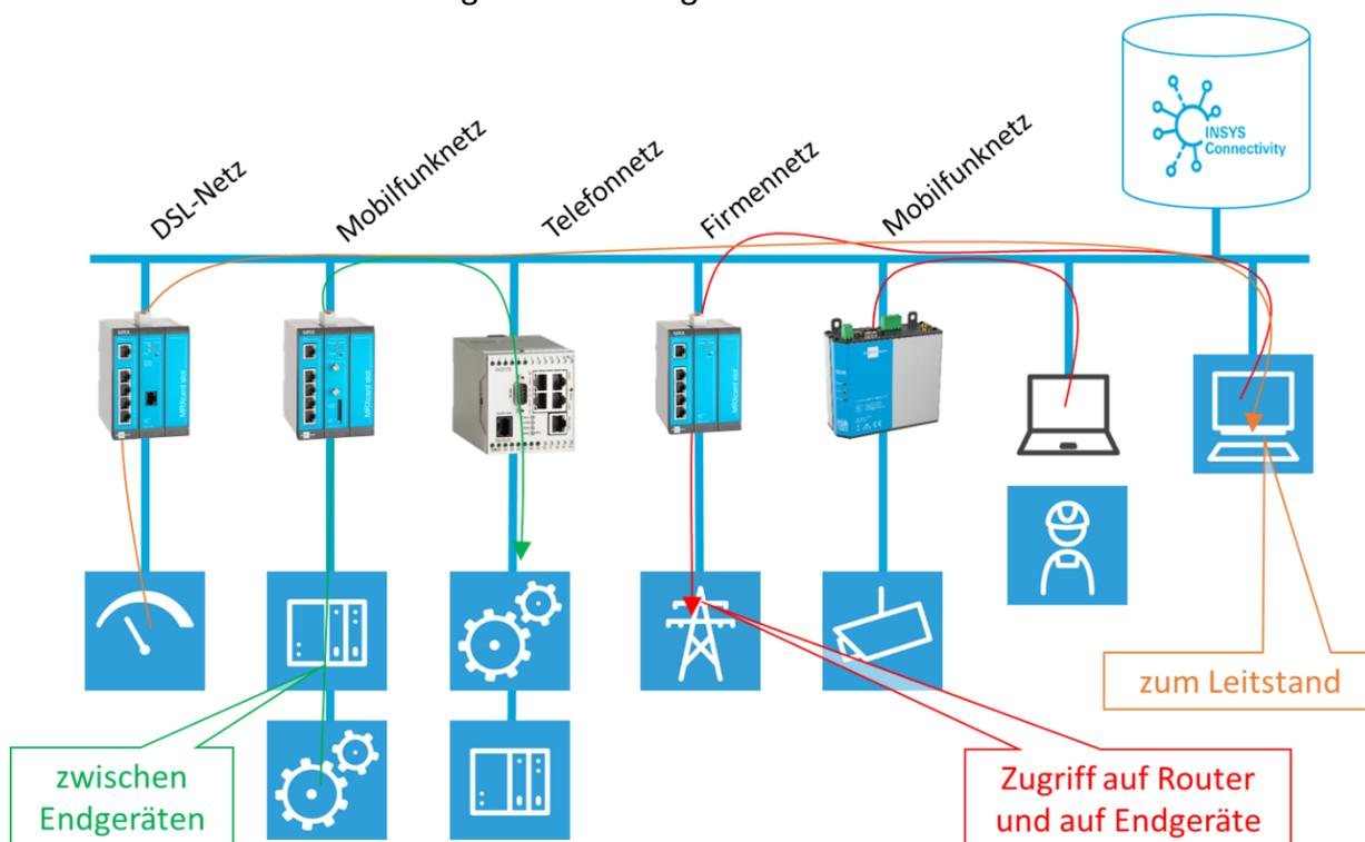
Die icom Connectivity Suite – VPN (VPN-Server) sorgt für den Austausch der Routing-Informationen, indem er dies jedem VPN-Client bei der Anmeldung mitteilt. Bei einer Änderung am VPN-Netzwerk wird der Server neu gestartet, so dass eine erneute automatische Anmeldung jedes Clients erforderlich ist wobei die Routing-Informationen aktualisiert werden.
