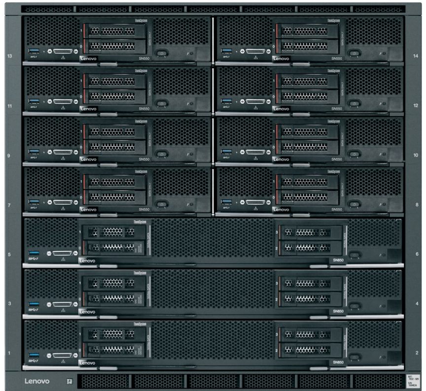
Das Flex System Enterprise Chassis kann für eine sehr hohe Dichte bis zu 7 SN850 Nodes integrieren.
