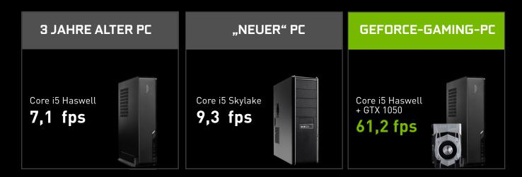
Das Upgrade könnte nicht einfacher sein. Da die Leistungsaufnahme der GeForce GTX 1050 bei nur 75 W liegt, benötigt diese Grafikkarte keine externe Stromversorgung. Integrierte Grafiklösungen können mit den Anforderungen der aktuellen Games nicht mithalten. Doch bei PCs mit einer GeForce GTX 1050 steigen die Frameraten fast um das Neunfache auf über 61 fps.
