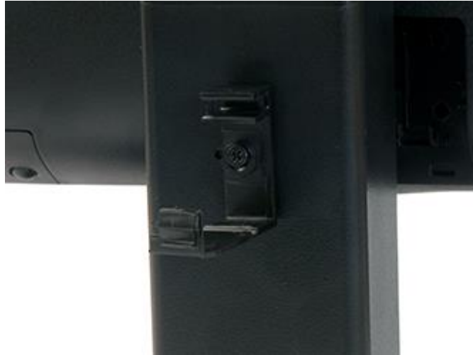
Kabelführung auf der Rückseite des Standfußes.
