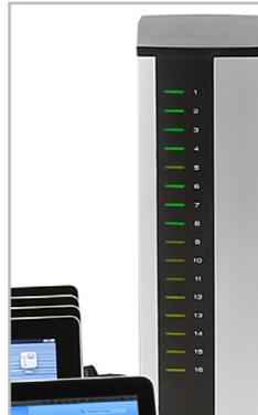
Individuelle Statusanzeigen (ISI)-LEDs geben den Ladezustand aller Tablets auf einen Blick an. Ein gelbes Licht gibt an, dass das Tablet gerade geladen wird, während eine grün leuchtende Anzeige darauf verweist, dass das Tablet vollständig geladen ist.
