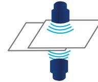
Der ADS-2100e verhindert per Multieinzugs-Erkennung über Ultraschall, dass mehr als eine Vorlage gleichzeitig eingezogen wird. So wird kein Dokument ausgelassen.
