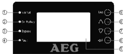
1. „Normal“: Die grüne LED leuchtet, wenn die USV die Verbraucher mittels Wechselrichter mit Spannung versorgt (Normalbetrieb).
