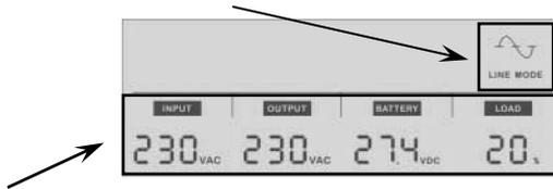
Die untere Hälfte des Displays zeigt die Ein- (INPUT) und Ausgangsspannung (OUTPUT) der USV, die Batterie(lade-)spannung (BATTERY) sowie die prozentuale Auslastung (LOAD) der USV.
