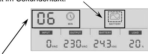
Die verbleibende Überbrückungszeit wird während des Batteriebetriebs in Abhängigkeit von der anliegenden Last in Minuten angezeigt, symbolisiert durch das Laufzeit-Piktogramm „MIN“.
