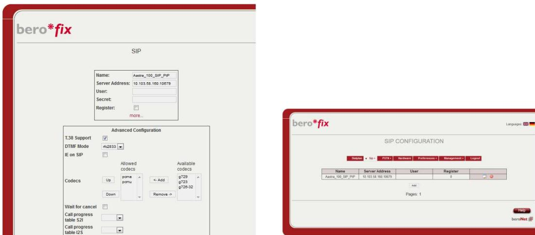
Unter dem Punkt „Server-Address“ muss die IP-Adresse der Mitel 100 sowie die eingestellte Portnummer des entsprechenden SIP-Profile („Own Port“, hier 10679) getrennt von einem Doppelpunkt konfiguriert werden. Es ist darauf zu achten, dass die Portnummer in der Mitel 100 eindeutig ist, und an keinem anderen Provider vergeben ist! Am besten übernimmt man hier den Vorschlag der Mitel 100.
