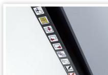
Die Funktionsleisten an jeder Seite des Boards erlauben einen schnellen Zugriff auf die am häufigsten verwendeten Werkzeuge.
