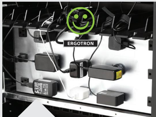
Ergotron flexibles Design nimmt eine Vielzahl von Steckernetzteil-Ausführungen für Adapter auf, die nicht in standardmäßige Mehrfachsteckerleisten passen.
