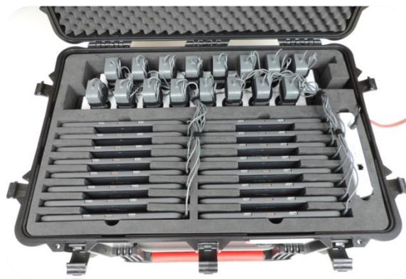
Seitlich am Koffer befindet ein RJ 45 Anschluss sowie der Anschluss für das Stromkabel, das zusätzlich durch eine FI- Personenschutz-Sicherung abgesichert ist. Da es sich beim Anschlusskabel um ein spezielles rotes Gummikabel handelt, legt sich dieses ohne Schlaufen auf den Boden - ohne Stolpergefahr.
