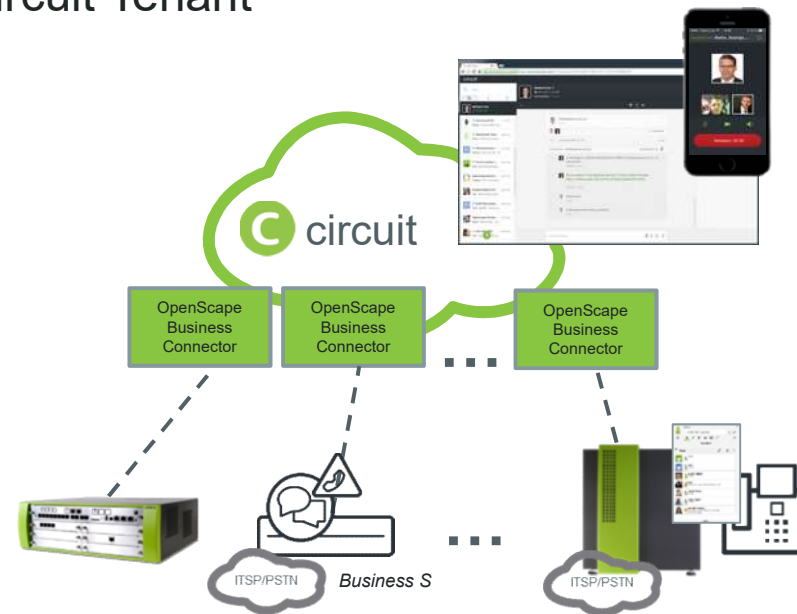
Mehrere OpenScape Business System verbunden mit einem Circuit Tenant
